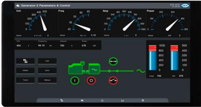
La serie AGI 400 de DEIF es una solución HMI completa que se conecta con todos los controladores Multi-line de DEIF, así como con equipos de terceros, utilizando protocolos de comunicación estándar.
