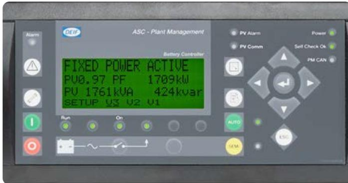
Diseñado para ser un vínculo confiable, totalmente integrado y optimizado entre plantas de energía sustentable y generadores, el ASC-4 Battery de DEIF permite una integración perfecta del almacenamiento energético en microredes híbridas.
